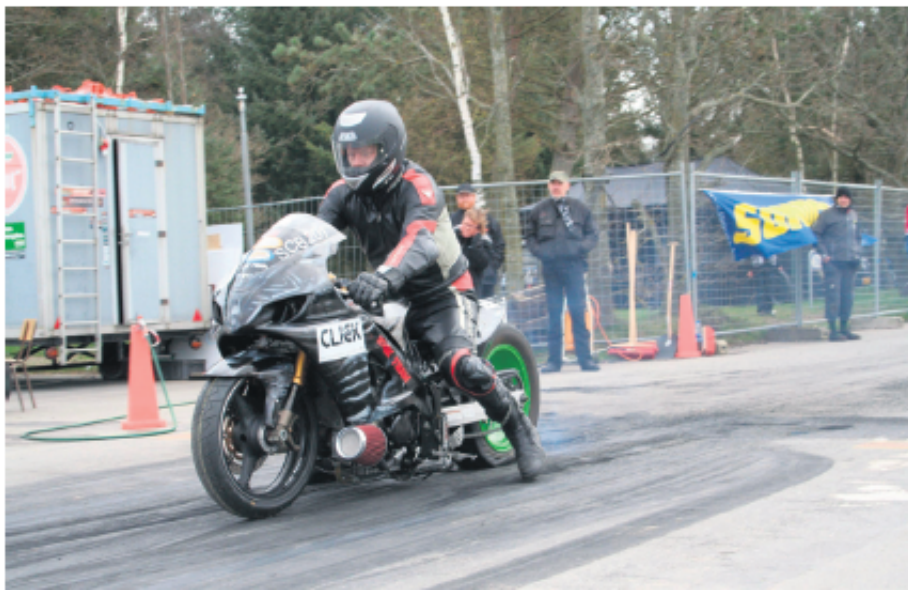
Per Emborg ved DM i dragrace. Man kan se, hvordan dækket bliver vredet rundt på fælgen i starten. Så ved han, at der er godt greb i asfalten. Ni sekunder senere er det ovre. Foto: Susanne Emborg.
